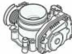
Drosselklappen-Steuereinheit J338 Integriert: Drosselklappensteller V60
